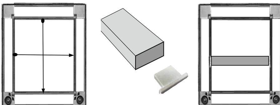
5. Corte la tela mosquitera dándole un margen sobrante de 0,5 cm. Coloque la tela sobre la estructura y comience a presionar el burlete de goma en la ranura para fijar la tela. No estire o tense la tela mientras coloca el burlete en los primeros dos perfiles, hágalo en los dos últimos. Recorte la tela que sobra con una cuchilla o cúter.
