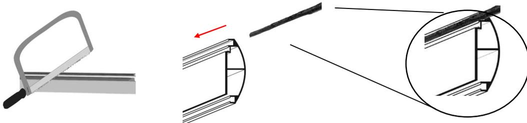
2. Introduzca las escuadras en los perfiles para montar la estructura. Las escuadras con rodamientos irán en la parte inferior de la mosquitera.
